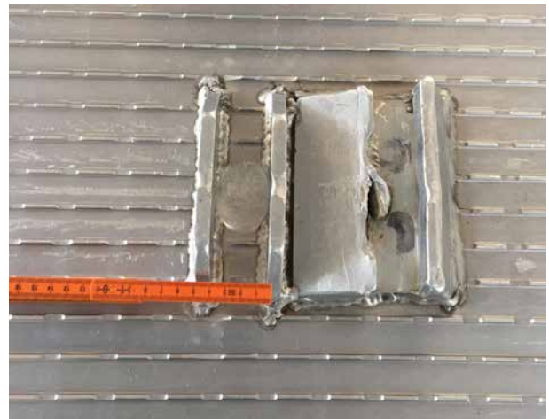
Risque de blessure: verrouillage fixé au plancher du véhicule avec une fente très large.
