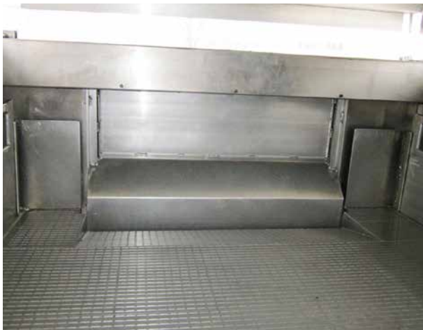
Des surfaces inclinées ne sont pas incluses dans la surface de chargement.
