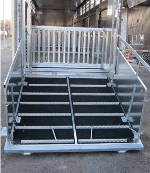
Une rampe bien équipée facilite le chargement et le déchargement: parois de protection latérale, revêtement antidérapant et sans fentes.
