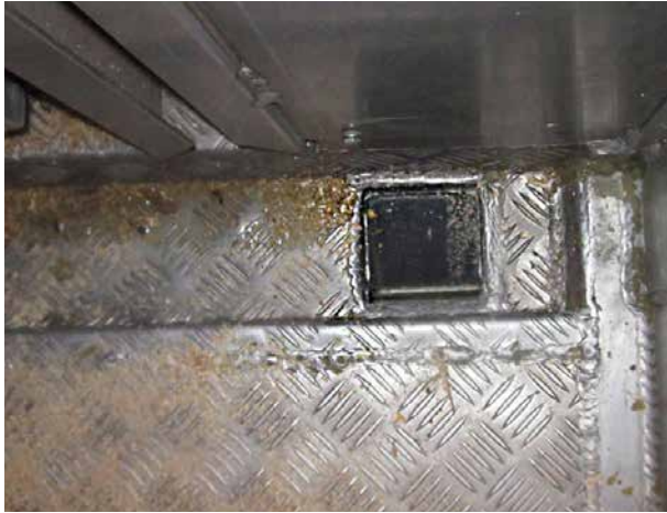
Rinnen, die tiefer als 2 cm abgesenkt sind, werden nicht zur Ladebodenfläche gezählt.
