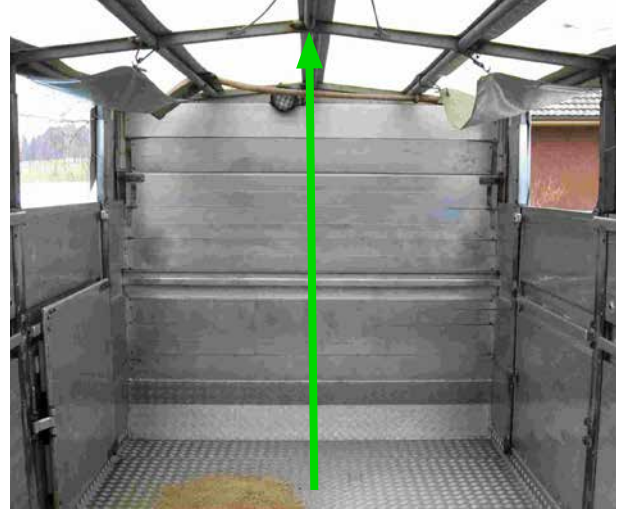
Abteilhöhe: Gemessen wird die lichte Höhe am niedrigsten Punkt des Fahrzeugs (Verstreibungen etc. ...)
