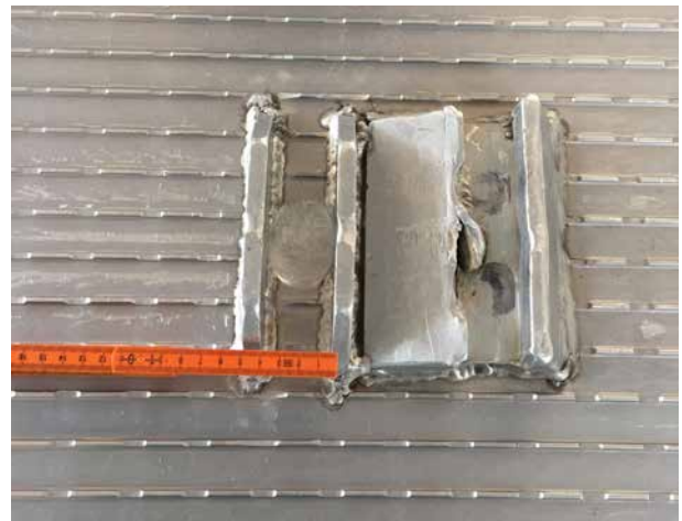
Bodenverriegelungen mit breiten Spalten stellen eine Verletzungsgefahr für die Tiere dar.
