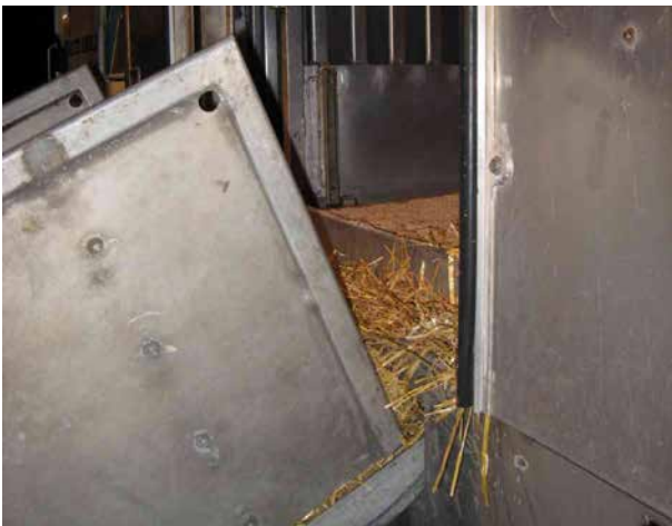
Löcher zwischen Seitenschutz und Fahrzeugwand.
