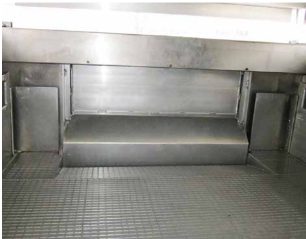
Schräge Flächen werden nicht zur Ladebodenfläche gerechnet.
