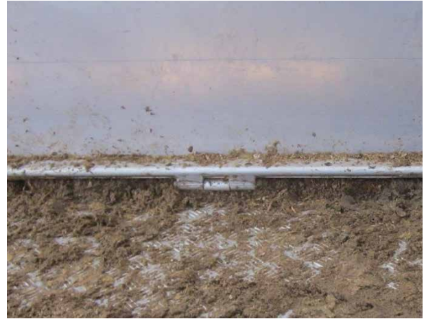
Steckleisten für Trenngitter, die sich auf einer Höhe tiefer als die Fesselgelenke der Tiere befinden, werden nicht zur Ladebodenfläche gezählt.
