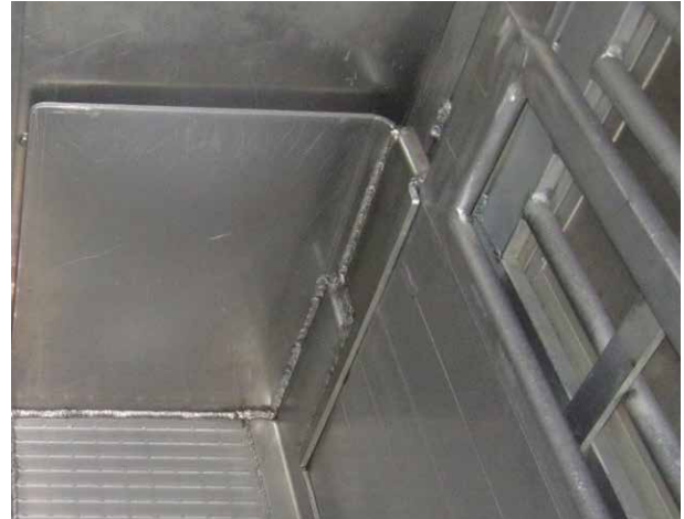
Seitliche «Wannenränder» verhindern ein Einklemmen zwischen beweglichen Teilen.
