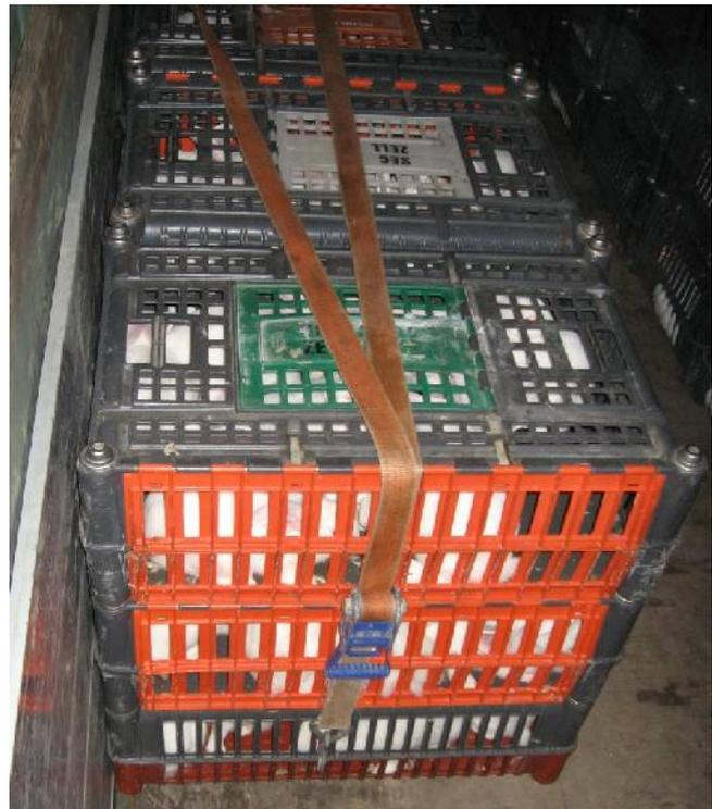
*Sicherung der Transportkisten mit Spanngurten*
