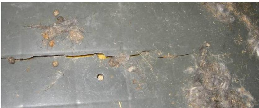
*So bitte nicht! Keine defekten und verschmutzten Transportkisten verwenden. Risse, scharfe Bruchkanten und spitze Teile stellen eine Verletzungsgefahr dar.*
